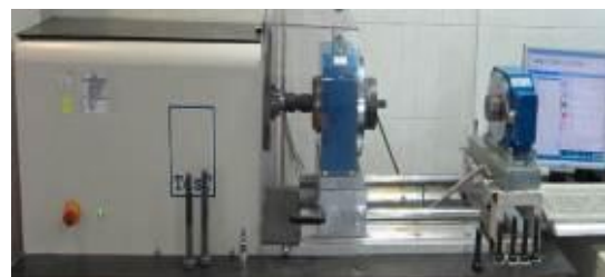
شکل ۴- دستگاه آزمون اصطکاکی
