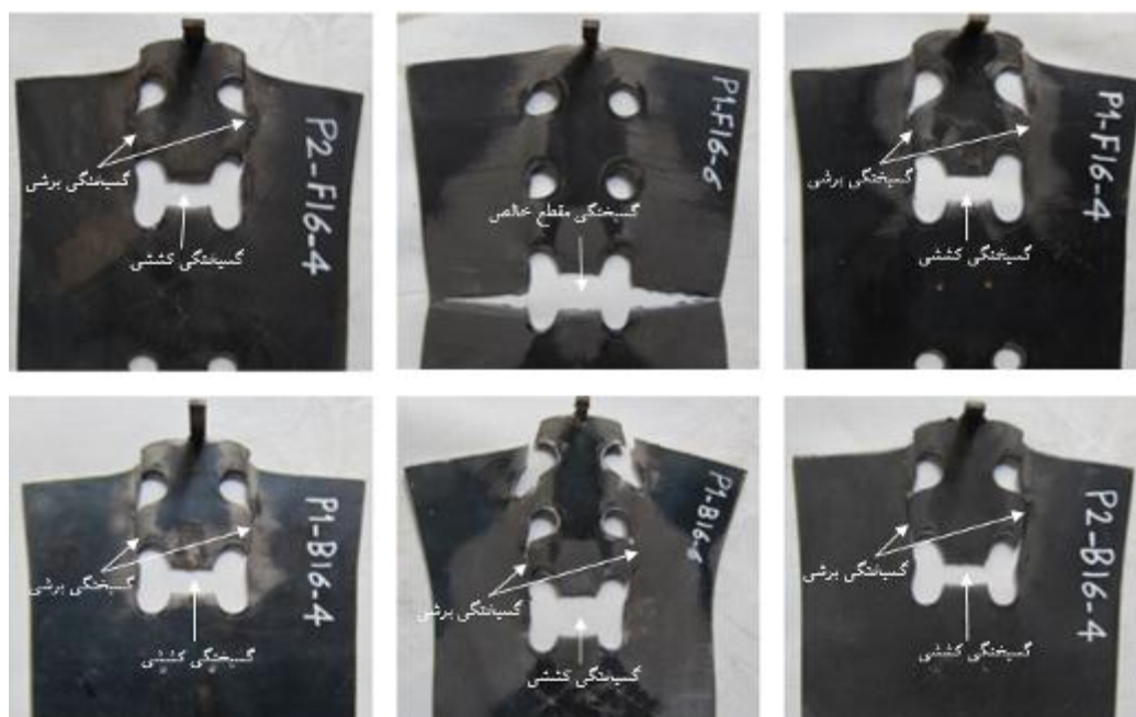
شکل ۶- مسیر شکست نمونه‌های آزمایش
